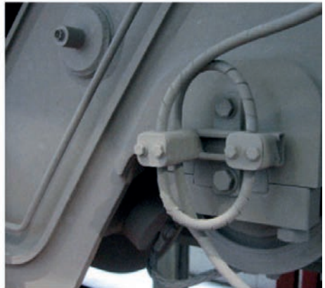
Situation corrigée: nouvelle position du câble
