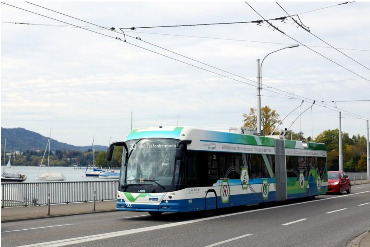
Abbildung 2 Der Swiss Trolley-Plus vom Schweizer Hersteller Hess, welcher mit In-Motion-Charging nachgeladen wird und rund 10 Kilometer ohne Oberleitung fahren kann (Vogel 2018).
