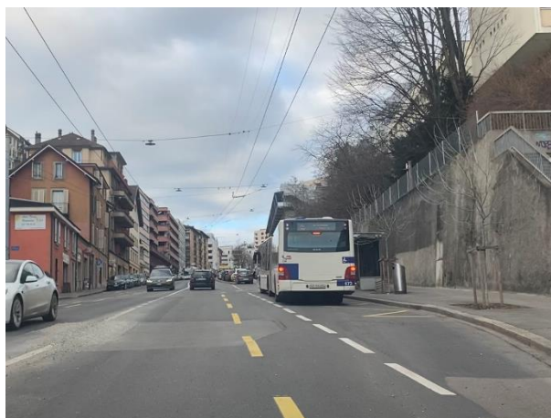
Figure 100 : Mauvais alignement dû à la difficulté de la manœuvre d'accostage
