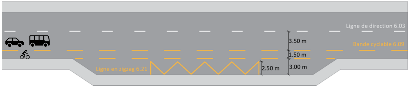
Figure 40 : Schéma type d'un arrêt hors chaussée bordé d'une bande cyclable
