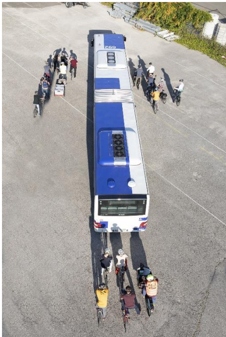
Figure 101 : Angle mort d'un bus (Source : TL)
