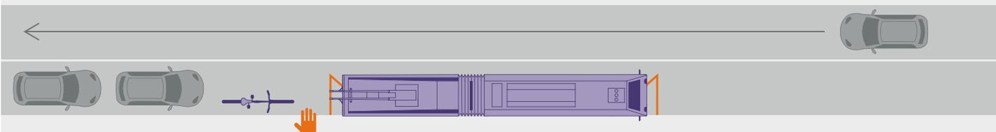
Les vélos utilisent la chaussée, l'arrêt est sur la chaussée (avec ligne de sécurité).
