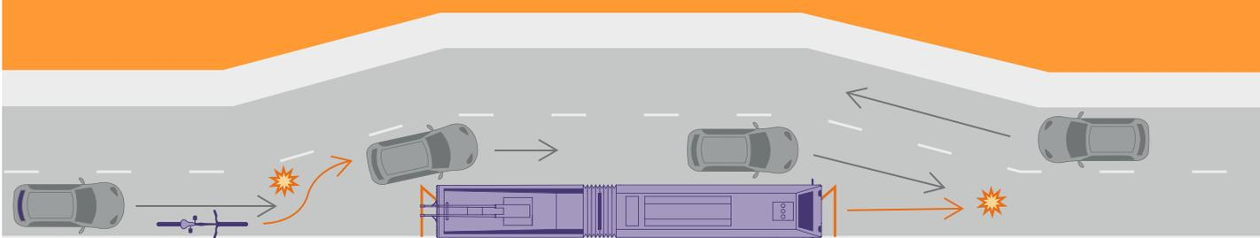
Les vélos utilisent la chaussée, l'arrêt est à droite sur une chaussée élargie.
