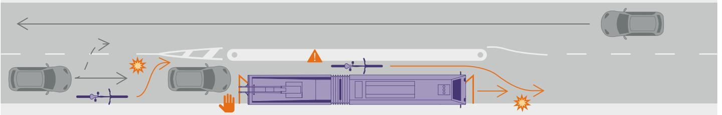
Les vélos utilisent la chaussée, l'arrêt est sur la chaussée (avec îlot central). Les vélos dépassent à gauche entre le bus et l'îlot central, tandis que les voitures doivent attendre
