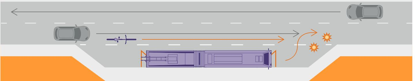
Les vélos utilisent la chaussée, l'arrêt est dans une baie d'arrêt. Les vélos passent à gauche du bus sans l'éviter
