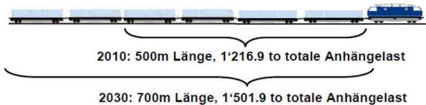
**Abbildung 18** Erhöhung Kapazität durch Verlängerung der Zugkomposition
